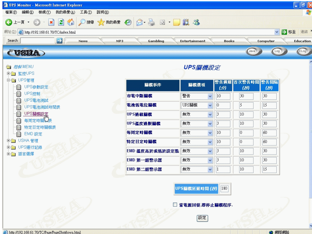
圖表3-12 UPS 管理頁面: UPS之關機設定
