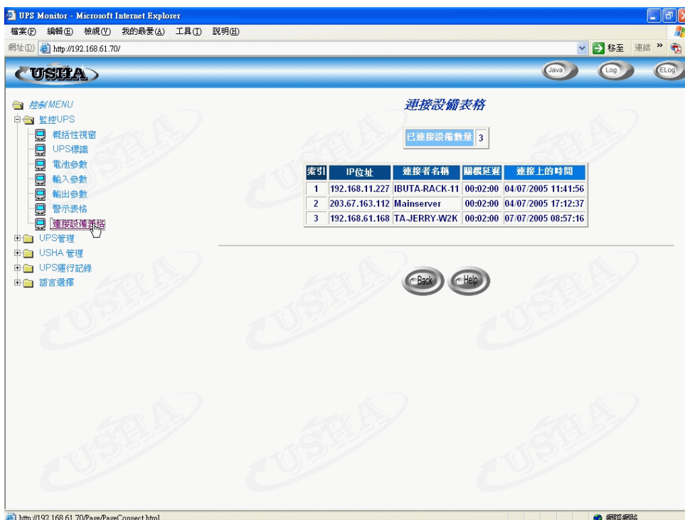
圖表3-7 USHA 之監控頁面：連接設備表格
