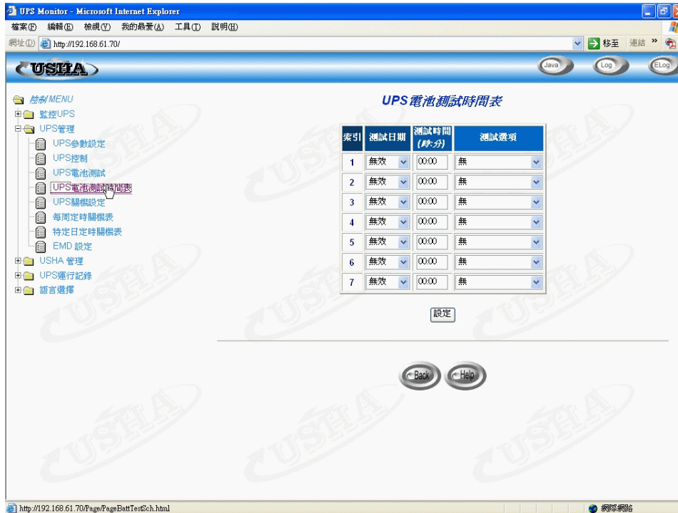
圖表3-11 UPS 管理頁面: UPS之電池測試時間表
