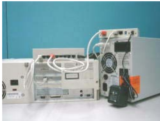
圖表2-20 從USHA ProE II的「區域網路」埠連接乙太網路電纜
