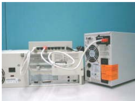
圖表2-19 從USHA Card的「區域網路」埠連接乙太網路電纜
