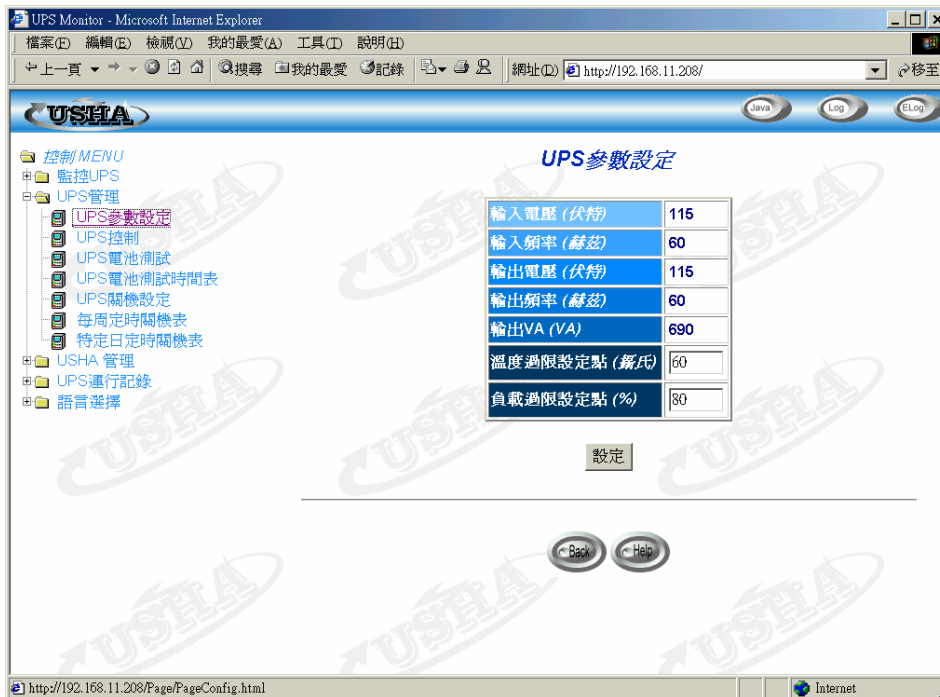
圖表3-8 UPS 管理頁面: UPS之參數設定
